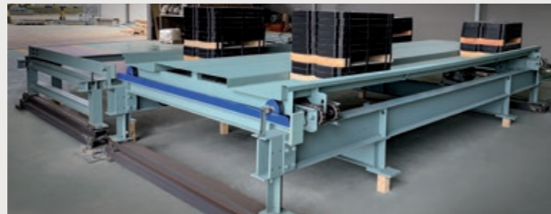
리프트 횡행 내구성 테스트(5만 회)
