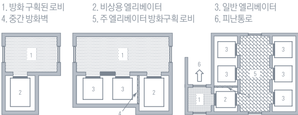
그림 8.1 단독 비상용 엘리베이터 및 방화구획된 로비의 배치도
